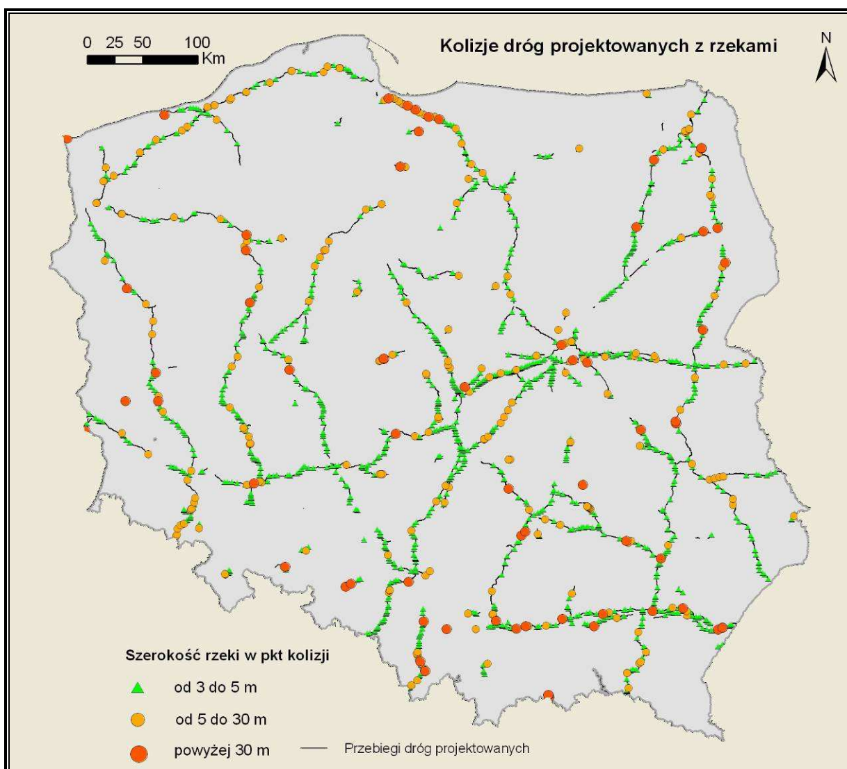
Rys. 9.7 Kolizje planowanej sieci drogowej z wodami płynącymi
