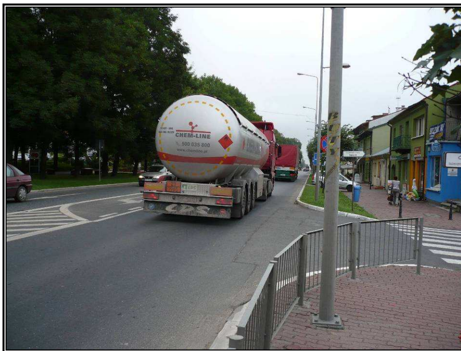
Fot. 7.15 Cysterna jadąca przez centrum Serocka w kierunku Wierzbicy. Tablica ADR informuje, że wiezionym ładunkiem jest silnie emitująca i łatwopalna mieszanina węglowodorów (gaz skroplony).
