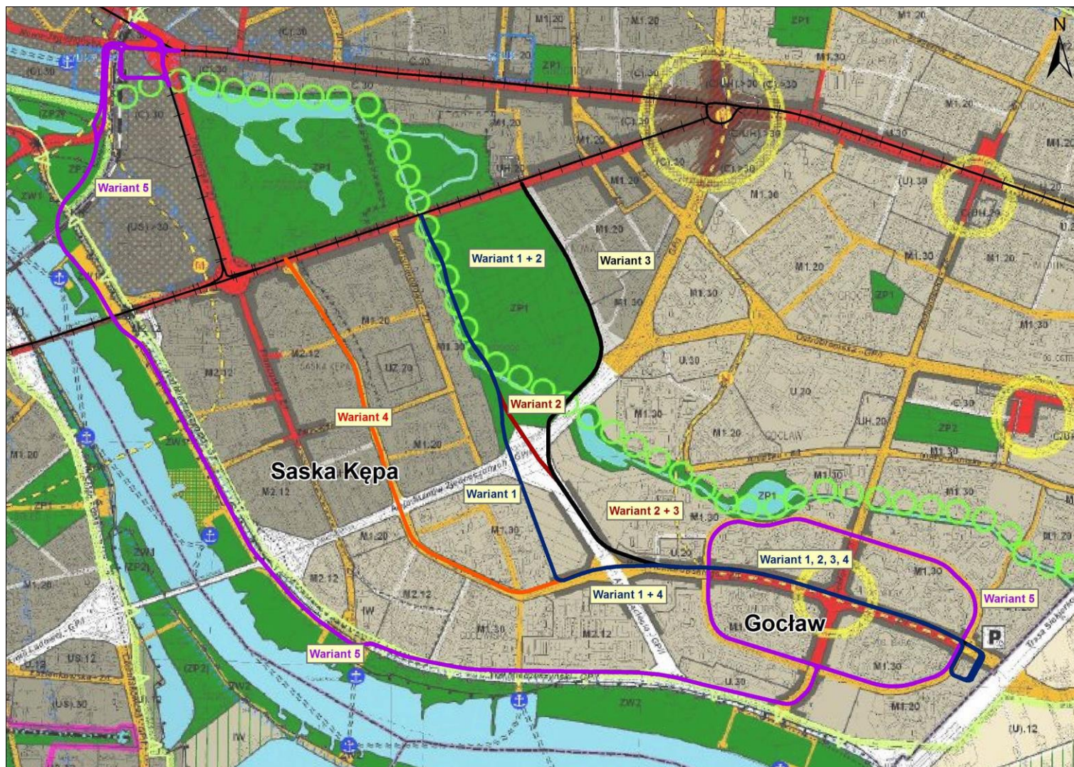
Rysunek 5-1 Przebieg wariantów tras tramwajowych na tle przeznaczenia terenów wg SUiKZP
