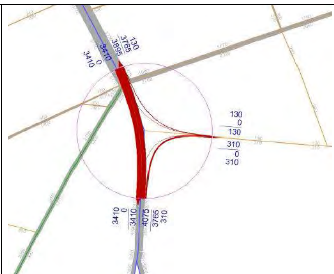
Rys. 0.17. Prognoza struktury kierunkowej ruchu na skrzyżowaniu ul. Raszyńskiej z ul. Koszykową w wariancie 1.
