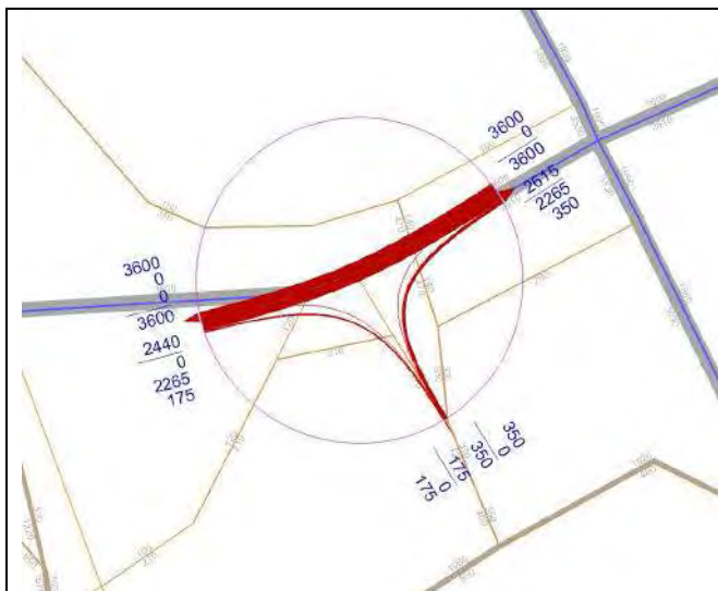
Rys. 0.24. Prognoza struktury kierunkowej ruchu na skrzyżowaniu ul. Słomińskiego z ul. Szymanowską w wariantcie 2.
