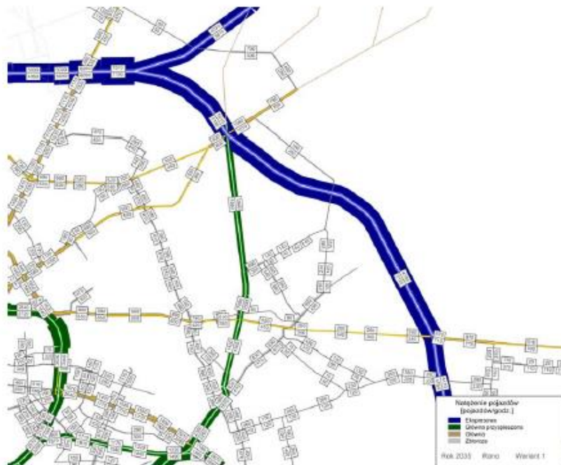
Rys. 5. Natężenie ruchu w rejonie węzła S17/DW631/DW634 w godzinie szczytu porannego w 2035 r.
