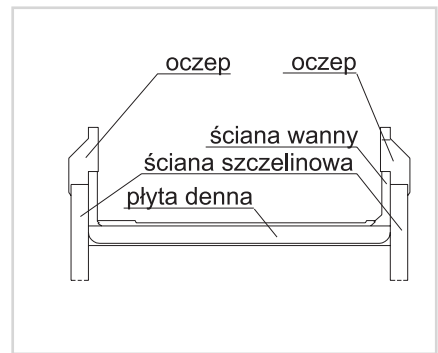
Rys. 9. Przekrój tunelu jednonawowego w części dojazdowej na południu – przekrój D
