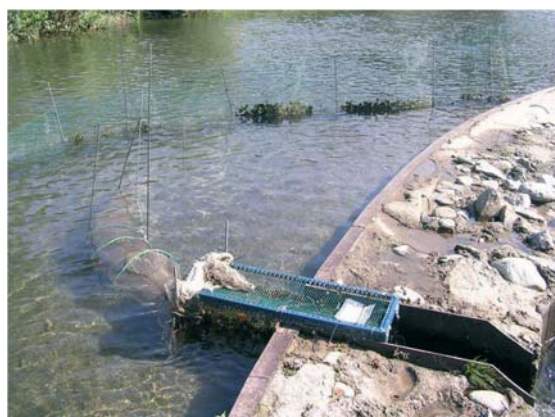
Rysunek 4.23. Kontrola urządzenia przepływu ryb za pomocą wężyczy, w tym przypadku umieszczonych na grobli. Zdjęcie: Quim Pou-CERM.
