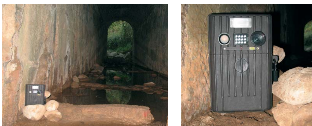
Rysunek 4.20. Instalacja systemu zintegrowanego z aparatem cyfrowym, oświetlenie za pomocą flesza lub diody LED na podczerwień (dla noktowizji) i pasywny czujnik podczerwieni (PIR), który uruchamia się przy zmianach temperatury podczas przechodzenia zwierząt. Zdjęcia: Minuartia.
