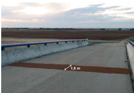
Rysunek 4.12. Rozmieszczenie pasów kontrolnych (piasek drobnoziarnisty) na przejściu zintegrowanym nad drogą. Zdjęcie: TEG-UAM.
