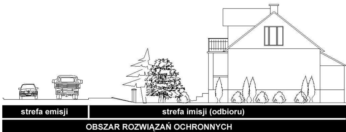
Rys. 7.3. Strefy emisji i imisji hałasów oraz obszar rozwiązań ochronnych w uniwersalnym podejściu do ochrony przed hałasem drogowym
