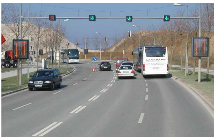
Fot. 7.4. Przykład sterowania ruchem na drodze jednojezdniowej, czteropasowej w pobliżu terenów targowych, gdzie następują znaczne problemy z płynnością ruchu w określonych kierunkach i porach dnia (Niemcy – Monachium)
