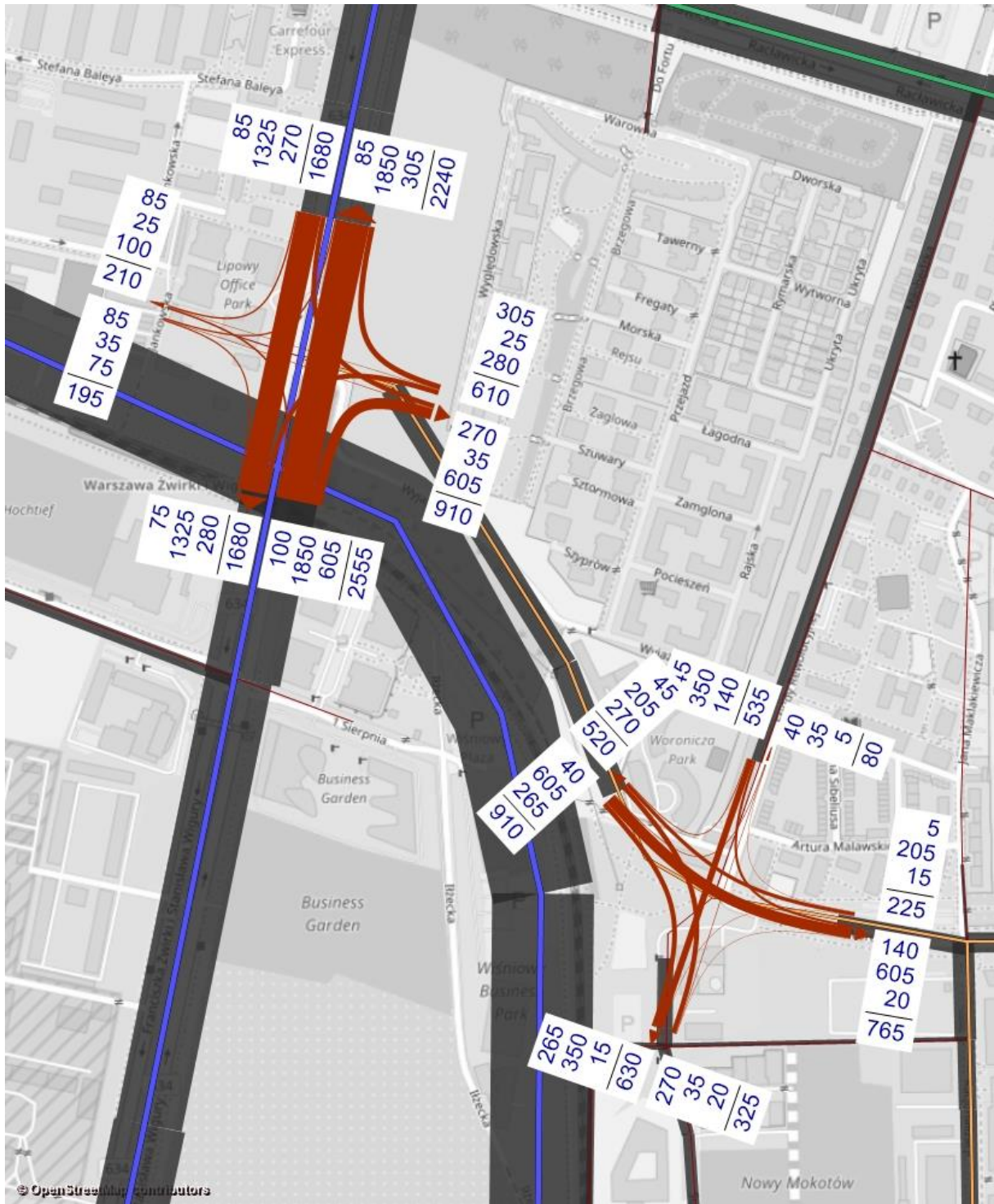
Rys. 4.5. Wyniki prognoz ruchu drogowego w rejonie Służewca Przemysłowego – wariant 1, szczyt poranny, rok 2040 – kartogramy ruchu na skrzyżowaniach (liczba pojazdów/godzinę).
