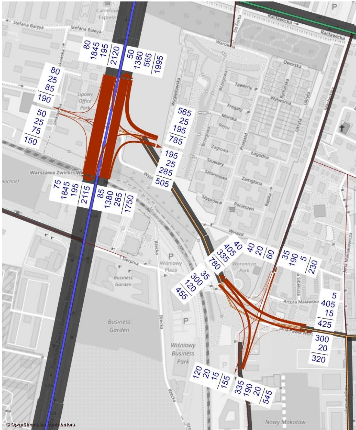
Rys. 5.27. Wyniki prognoz ruchu drogowego w rejonie Służewca Przemysłowego – wariant 3, szczyt popołudniowy, rok 2025 – kartogramy ruchu na skrzyżowaniach (liczba pojazdów/godzinę).
