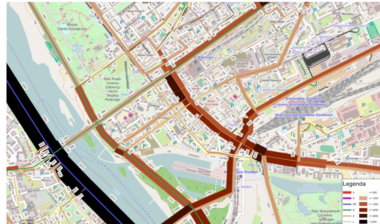
RYS. 19 PROGNOZA RUCHU PO POWSTANIU TRASY ŚWIĘTOKRZYSKIEJ - NATĘŻENIA Z ZABUDOWĄ W PORCIE PRASKIM.
